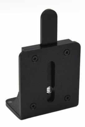
Accessoire servant à transformer un spot laser en un plan laser. Une lentille convertit le faisceau laser en un plan laser perpendiculaire à la table de travail, permettant ainsi de rendre visible le trajet du laser. La hauteur de la lentille est ajustable de manière à aligner celle-ci avec la majorité des lasers du marché. Deux aimants placés sous le support lui confèrent une bonne adhérence sur une surface en acier (tableau, ensemble réflexion réfraction, etc).
