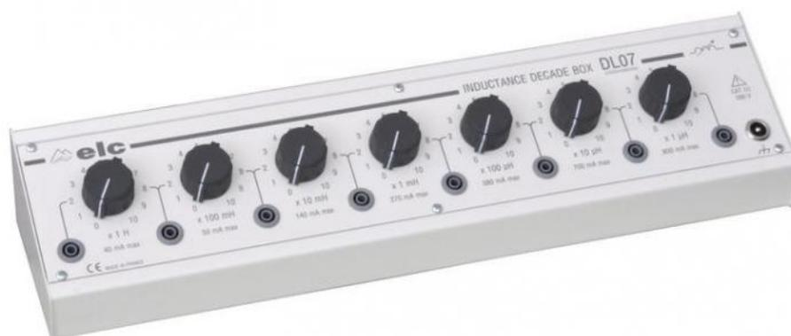
Coffret métallique blanc connecté à une prise de terre, avec 7 commutateurs rotatifs à 11 positions. Les connexions s'effectuent sur des douilles bananes sécurisées Ø4 mm, avec des sorties sur chaque décade. Douille de terre de sécurité.
