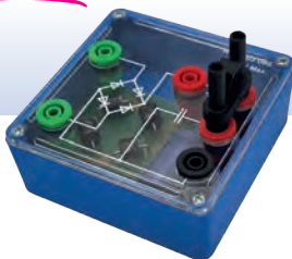
Module pont de diodes et condensateur Le pont de diodes est constitué d'un module en boîtier avec douilles de sécurité permettant d'étudier le redressement et le filtrage du courant alternatif. Le boîtier contient un pont de diode et un condensateur de filtrage de 2200µF. Le pont de diode accepte une tension jusqu'à 15V et un courant jusqu'à 5 A Livré avec un shunt pour relier le pont de diodes au condensateur. Réf. P/CSS0056 Prix TTC : 39,00 €
