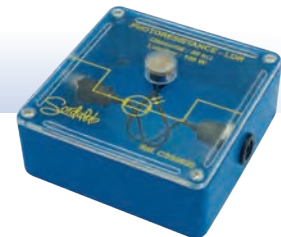
Photorésistance - LDR Obscurité : 50 kΩ Lumière : 100 Ω Réf. P/CSS0020 Prix TTC : 15,80 €
