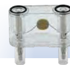
Photorésistance Ø 10 mm Résistance à la lumière : 100 Ohms Résistance à l'obscurité : 50 kOhms Réf. P/DQ045 Prix TTC : 21,10 €
