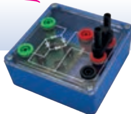
Module pont de diodes et condensateur Le pont de diodes est constitué d'un module en boîtier avec douilles de sécurité permettant d'étudier le redressement et le filtrage du courant alternatif. Le boîtier contient un pont de diode et un condensateur de filtrage de 2200µF. Le pont de diode accepte une tension jusqu'à 15V et un courant jusqu'à 5 A Livré avec un shunt pour relier le pont de diodes au condensateur. Réf. P/CSS0056 Prix TTC : 39,00 €
